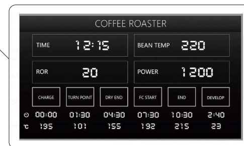
Panel digital para indicar el momento de las diferentes fases de tueste (carga, punto de retorno, fin etapa seca, inicio de primer crack, fin de primer crack, tiempo de desarrollo)
