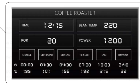
Panel digital para indicar el momento de las diferentes fases de tueste (carga, punto de retorno, fin etapa seca, inicio de primer crack, fin de primer crack, tiempo de desarrollo)
